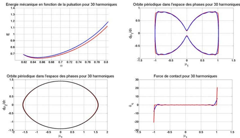
FIG. 4 – Solution analytique (en rouge) et numérique (en bleue) pour le premier mode. a) Énergie en fonction de la pulsation. b) Orbite périodique dans l'espace  $(\mu_1, \frac{d\mu_1}{dt})$ . c) Orbite périodique dans l'espace  $(\mu_2, \frac{d\mu_2}{dt})$ . d) Force de contact  $\phi$  et son approximation  $\phi_\eta$  en fonction du déplacement  $\mu_1$ .
