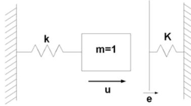
FIG. 1 – Modèle à un degré de liberté avec impact unilatéral.
