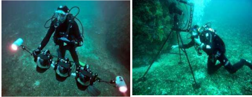
Figure 11. A gauche les trois appareils photographiques synchronisés, à droite la caméra 3D, sonar haute fréquence de marque Blue View, monté sur trépied
