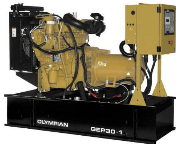
Figure 6 : groupe électrogène OLYMPIAN™ GEP30-1 Caractéristiques : 380-415 V, 50 Hz, 30 kVA, régulateur de tension R250 ( \pm 0,5\% ), excitation shunt auto-excité, THD V\% à vide = 4%.
