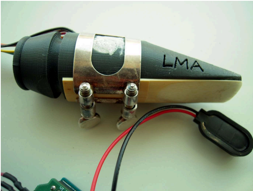
Figure 3. Gros plan du bec instrumenté, (Laboratoire de mécanique et d'Acoustique), 2017, fiche inventaire PATSTEC.
