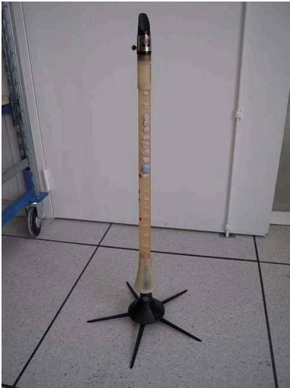
Figure 1. Prototype de la clarinette logique (CAGIMA, projet de recherche fondamentale) dont les différentes parties de l'instrument sont construites par modélisation, (Laboratoire de mécanique et d'acoustique), 2017, fiche inventaire PATSTEC
