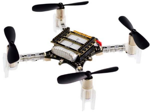
Figure 11. Quadrirotor Crazyflie 2.0 équipé de quatre micromoteurs à courant continu [16]. Dans sa version commerciale, la chute de tension batterie n'est pas compensée au cours du vol, limitant ainsi son vol à seulement 7 minutes.
