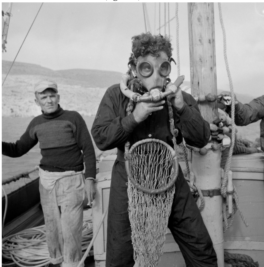
Figure 2 Modèle d'appareil Fernez II postérieur à la Seconde Guerre mondiale. Photographie Kimon Raphaelidis (1975-1983) ; collection Musée Benaki. © Φωτογραφικά Αρχεία Μουσείου Μπενάκη
