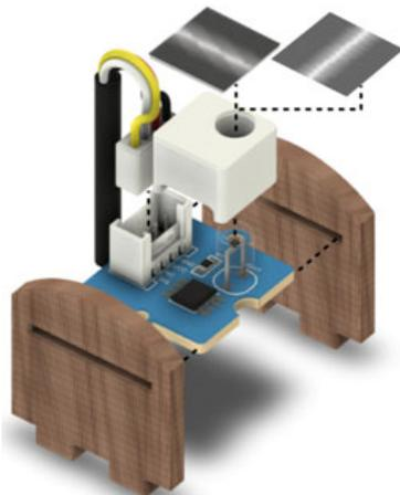
**Figure 6.** Photocapteur individuel composé d'un module Grove Light (photorésistance sur carte électronique), de 2 supports en bois, d'un support en plastique blanc servant d'isolant optique et de support pour le filtre polarisant posé au-dessus de la photorésistance. Les filtres sont découpés et collés. (D'après rapport étudiants N. Thellier et N. Thouvenel)
