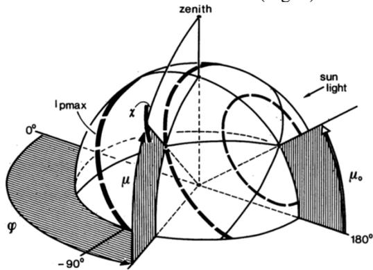
**Figure 2.** Illustration de la distribution de la lumière polarisée selon des cercles concentriques autour du soleil. Les angles  $\phi$  et  $\mu_0$  sont l'azimut et l'élévation du Soleil respectivement. L'angle  $\mu$  correspond à l'angle d'élévation  $m$  d'un point dans le ciel. Le vecteur  $\chi$  est un e-vecteur (cf. 2.1). D'après [7].
