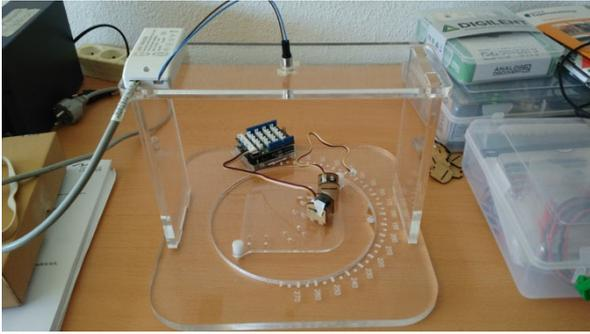
**Figure 4.** Dispositif expérimental pour l'apprentissage de méthodes d'estimation de cap à partir de la lumière polarisée. Le plateau est tourné manuellement. Les photocapteurs peuvent être disposés selon deux configurations possibles (cf. Fig. 7).
