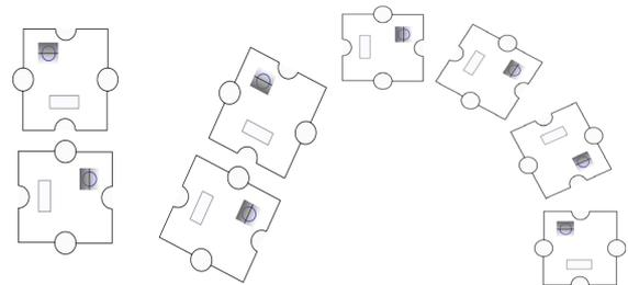
**Figure 7.** Représentation schématique des photocapteurs pour illustrer la configuration 2 à 2 (gauche) et circulaire (droite). Chaque photocapteur dispose ici d'un filtre polarisant représenté par un cercle barré.
