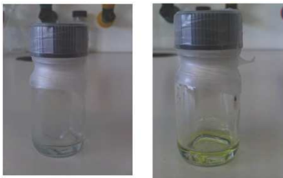
FIGURE 5.5 – Le trans-1,2-disiloxybenzocyclobutène incolore à froid (à gauche) prend une légère coloration jaune à température ambiante (à droite).
