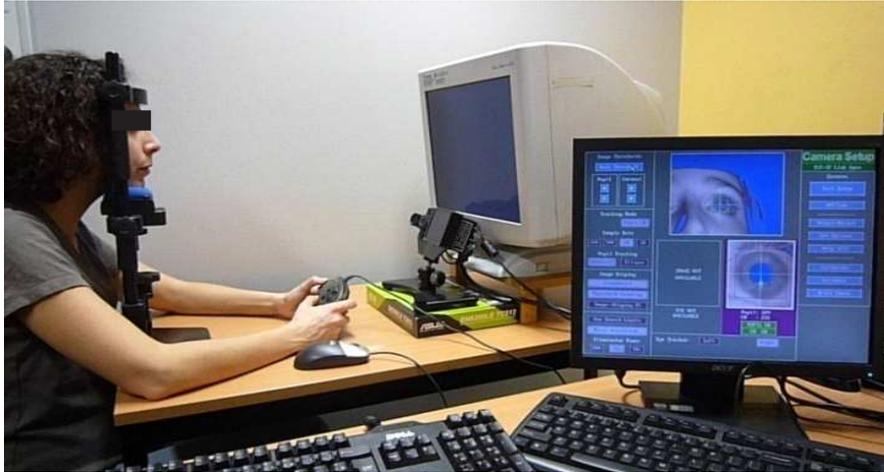
Figure A.30 : Dispositif expérimental utilisé pour l'oculométrie.
