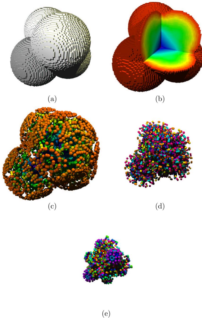
FIG. 7.2. Exemple : objet «4 boules» (a), carte de distance avec  $n_{3,4,5}$  (b), axe médian avec  $n_{3,4,5}$  (c), axe médian avec  $n_{29,41,51,d=65,e=71,f=88}$  (c) et axe médian avec  $d_E^2$  (d).
